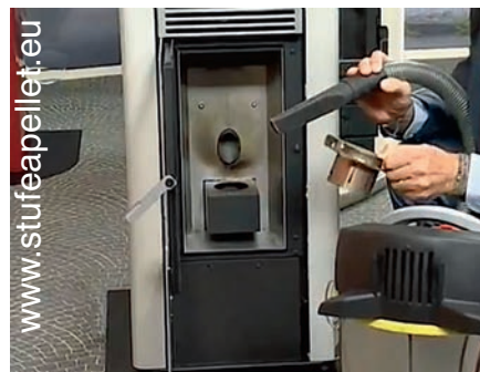
Le operazioni necessarie per la gestione di una stufa a pellet: il carico dei pellet e l'aspirazione della cenere della stufa.
